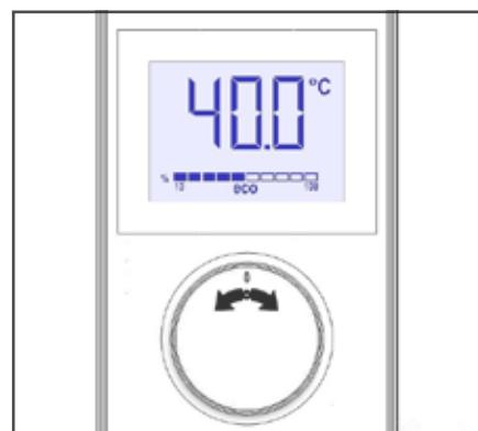
Der Betrieb des Geräts kann anhand des aktuellen Energieverbrauch am LCD-Bildschirm verfolgt werden. Das Gerät stellt die erforderliche Leistung, entsprechend der gewünschten Wassertemperatur automatisch ein. Die dabei verbrauchte Energie können Sie am LCD-Bildschirm verfolgen (von 10% bis 100%). Die „eco“-Anzeige unter der
